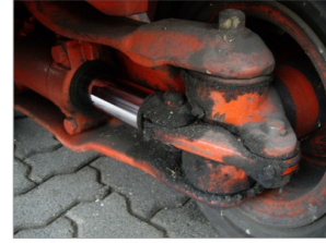
Ungepflegter, schlechter Allgemeinzustand – hier die Lenkachse eines Staplers.
