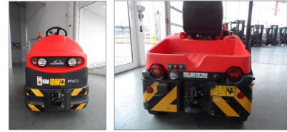
Ob Stapler oder wie hier ein Schlepper – die Lichtanlage muss funktionieren. Dies setzt Kontrolle voraus
